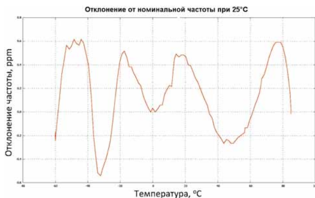
Рис. 2. ТЧХ генератора GK487-TK 12 МГц в диапазоне -60...+85°C
